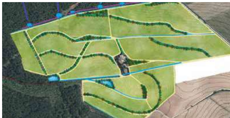
Exemple d'aménagement en hydrologie régénérative avec un dispositif en keyline réalisé par Alain Malard.
